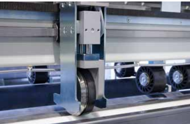
Einfaches Rillen gegen eine zylindrische Walze
